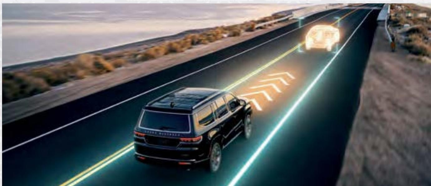
CONTROL DE VELOCIDAD DE CRUCERO ADAPTATIVO CON FUNCIÓN STOP & GO<sup>5</sup>: Mantiene automáticamente la velocidad deseada del vehículo y la distancia de los vehículos que se encuentran frente a ti. El sistema puede detener el vehículo por completo sin la intervención del conductor para ayudar a evitar una colisión.
