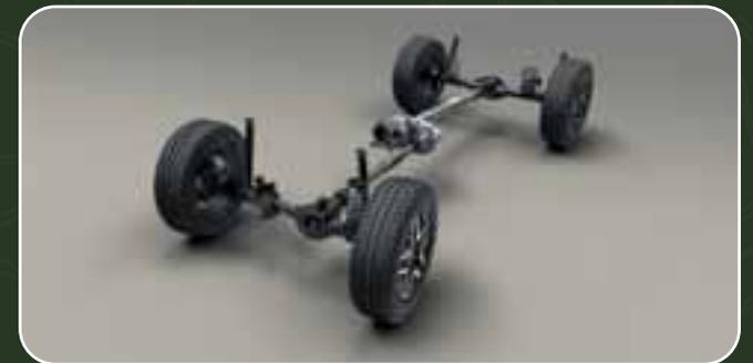
Mientras que el sistema Command-Trac® Part Time 4x4 proporciona torque a las cuatro ruedas para una tracción increíble. Su relación de rango bajo de 2.72:1 te permite trepar rocas y decir sí a todo tipo de aventuras.
