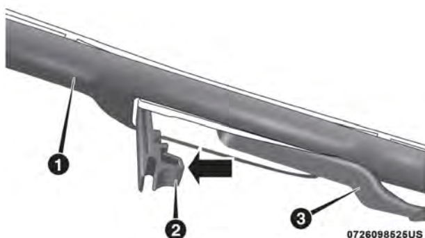
Pluma del limpiador con la pestaña en posición de liberación
