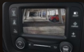
Cámara trasera de asistencia de estacionamiento ParkView® con guías activas
